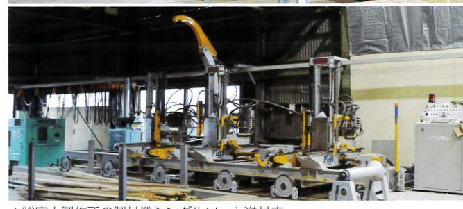
▲(株)富士製作所の製材機シングルソーと送材車
